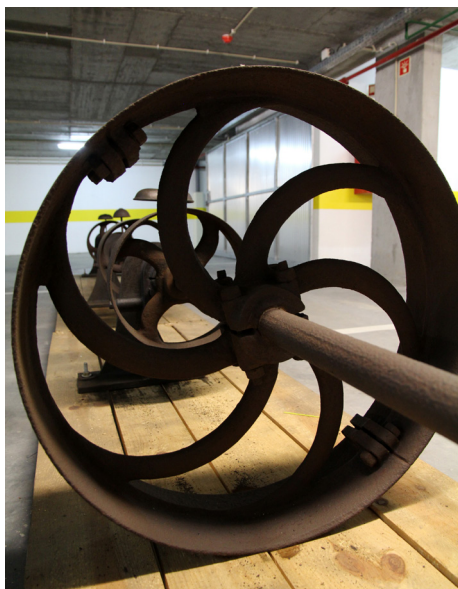
Figura 11 Veio de transmissão da Engomadoria Ramiro & Leão. Depósito do Rego Fonte: Museu de Lisboa
